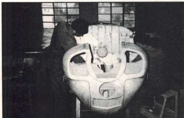
Aerotécnicos realizando inspección de 1.200 horas a un T-34 Mentor
